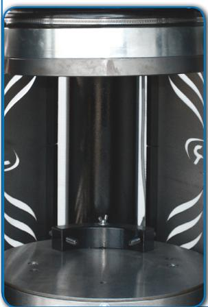
**Compression platens  $\varnothing$  370mm**
