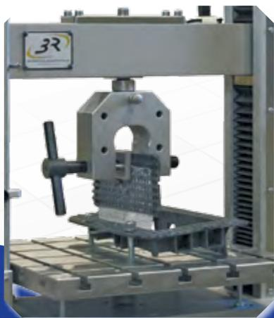
*Essai de résistance d'une trappe d'airbag*
