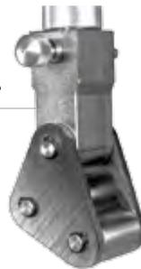
Mâchoires hydrauliques pour essais de traction de forte charge
